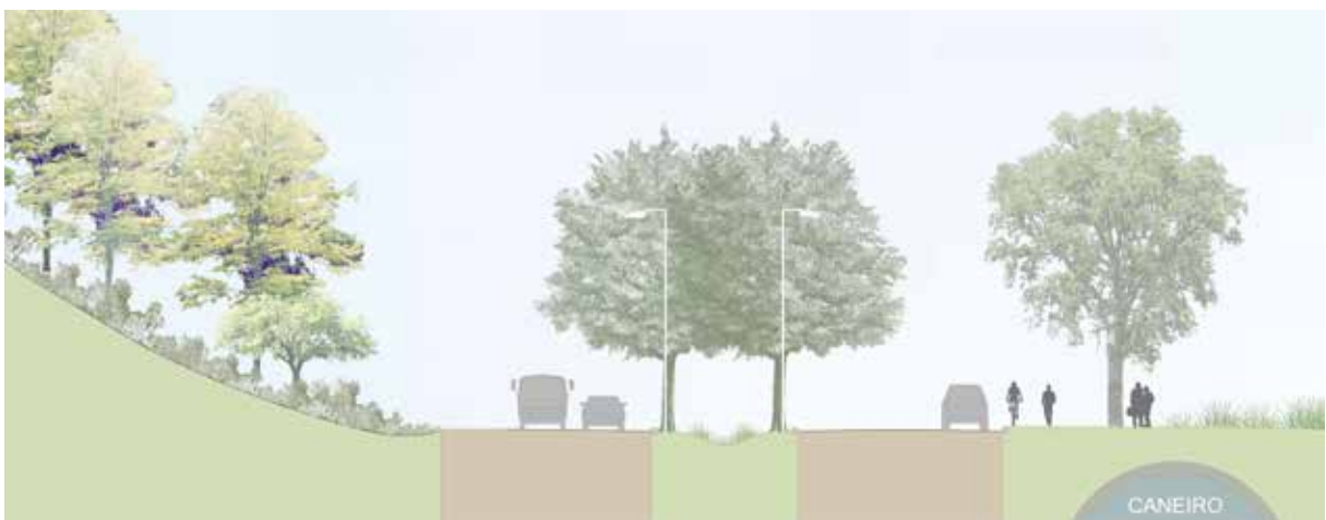
Pormenor da Avenida de Ceuta. A versão preliminar do Plano, previa a redução de duas faixas de rodagem, uma no sentido ascendente e outra no sentido descendente. O espaço conquistado ao sistema rodoviário, permitia o aumento do separador central para 6m, possibilitando a plantação de um duplo alinhamento de árvores, a existência de uma vala central de captação de águas pluviais e a sua fito-depuração antes da descarga no meio receptor. [Fonte: NPK-Arquitetos Paisagistas Associados]
